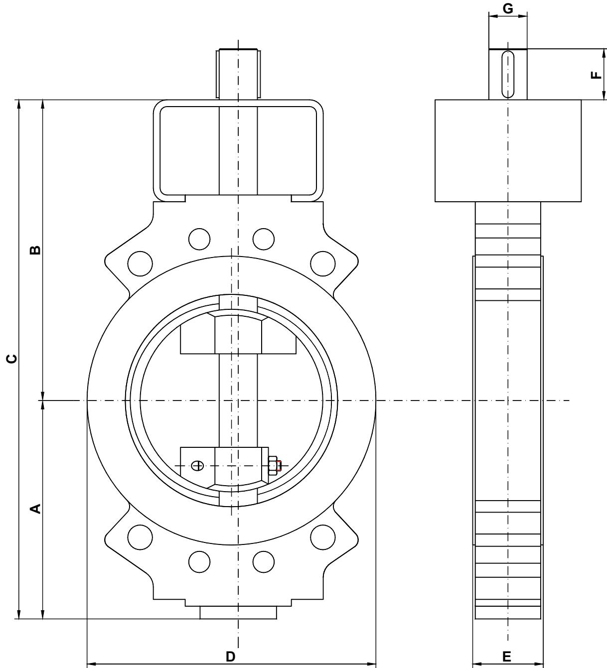
Flangiature secondo UNI/DIN PN 6-10-16-25-40-64-100 e ANSI 150-300-600. Per altre versioni contattare Delta Valves S.r.l.
