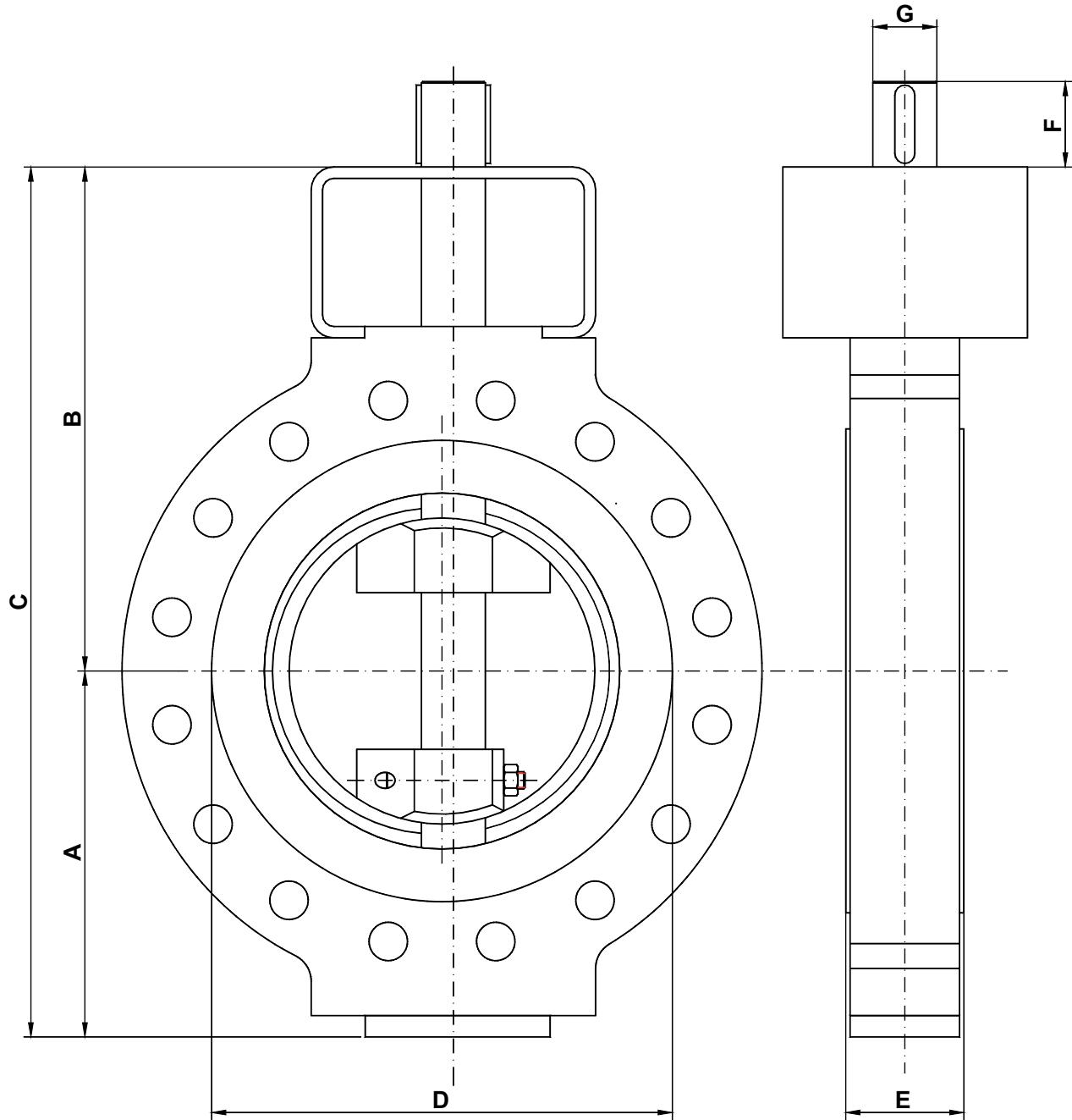
Flangiature secondo UNI/DIN PN 6-10-16-25-40-64-100 e ANSI 150-300-600. Per altre versioni contattare Delta valves S.r.l..
