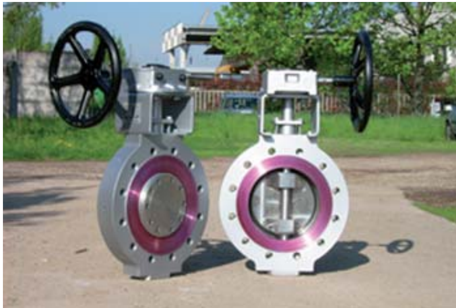
VALVOLA A FARFALLA TRIPLO ECCENTRICA - TIPO LUG - NPS 20" ANSI 300 RF TRIPLE OFFSET BUTTERFLY VALVE - NPS 20" ANSI 300 RF
